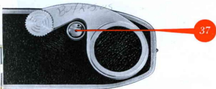
Zum Zurückspulen des belichteten Films wird der Umschaltknopf (37) an der Unterseite der Camera eingedrückt und der Rückspulknopf (20), damit er besser gedreht werden kann, halb (bis zum ersten Anschlag) herausgezogen. Darauf drehen Sie den Rückspulknopf so lange in Pfeilrichtung, bis sich der Umschaltknopf nicht mehr dreht. Damit dies besser beobachtet werden kann, ist er am Rande mit einem schwarzen Punkt versehen.
